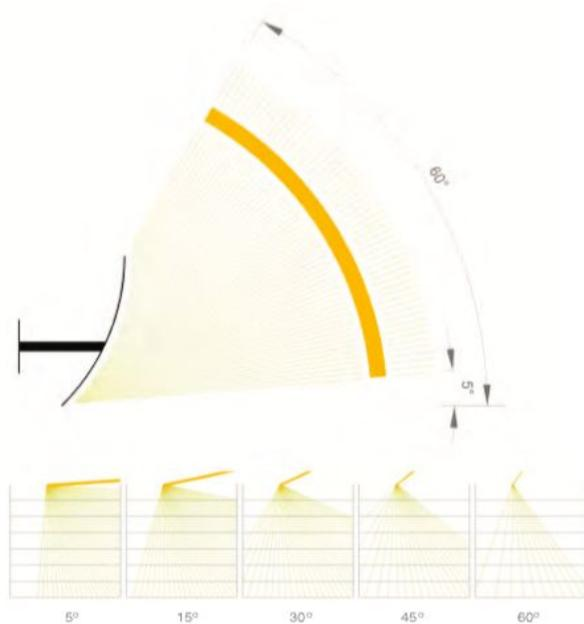
El rendimiento óptimo de los reflectores se consigue para alturas solares comprendidas entre los 5o y los 60o
